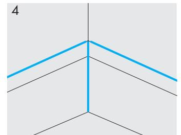
4 Füllen Sie die Verbindungen zwischen den Sockelleisten mit Verbindungskleber und die Verbindungen zwischen der Sockelleiste und der Wand mit Montagekleber.
