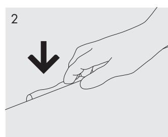
Dichten Sie die Dehnungsfuge ab.
