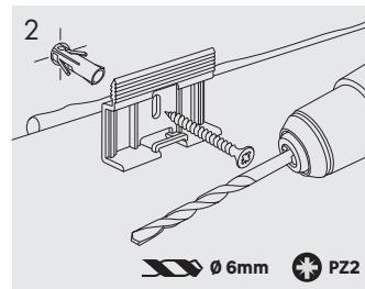
Bohren Sie ein Loch und schrauben Sie den Clip mit einer Schraube in die Wand.
