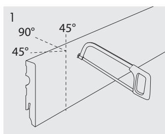
Couper la plinthe à 45° (pour les angles) ou à 90° (pour les joints).
