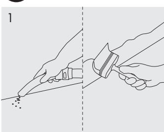
Préparer le support qui doit être dépoussiéré, sec et dégraissé. Il est recommandé d'appréter le mur où les plinthes seront collées.
