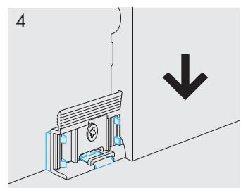
Placer la plinthe au-dessus du clip et appuyer fermement.
