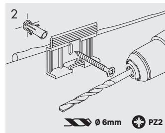
Percer un trou dans le mur et visser le clip dans le mur.
