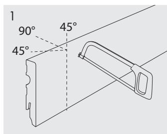
Schneiden Sie die Leiste in einem Winkel von 45° (Ecken) oder 90° (Verbindungen) zu.
