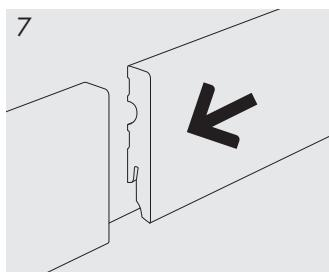
Coller les sections de plinthes sur le mur, appuyer dessus et laisser sécher.
