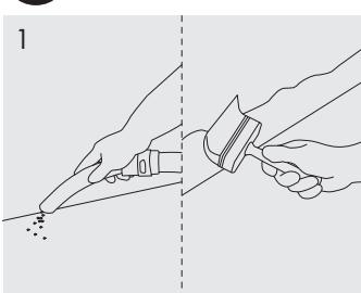
Bereiten Sie den Untergrund vor, der staubfrei, trocken und entfettet sein muss. Es wird empfohlen, die Wand an der Klebestelle zu grundieren.
