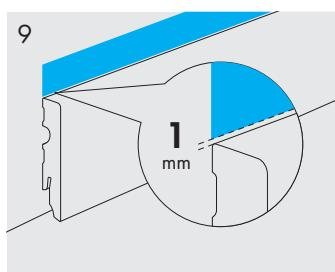
Appliquer du ruban-cache sur le mur à environ 1 mm au-dessus de la plinthe.
