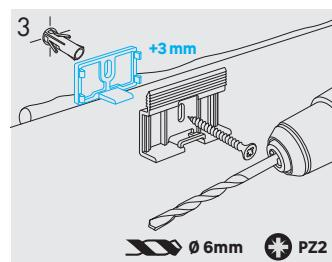
Bohren Sie ein Loch und schrauben Sie den Clip mit dem Abstandshalter mit einer Schraube in die Wand.
