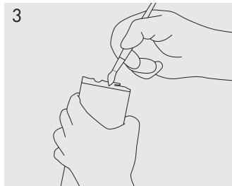
Imprégnier les surfaces découpées en utilisant une peinture de finition et laisser sécher.
