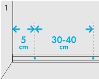
Platzieren Sie die Spreizdübel alle 30–40 cm, 5 cm von den Ecken entfernt.
