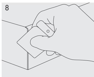
Sichern Sie die Verbindungen der Leisten mit der fertigen Spachtelmasse CREATIVA.
