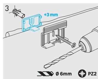
Percer un trou dans le mur, relier le clip à la cale d'espacement et visser le clip au mur.
