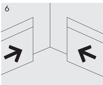
Coller les plinthes au mur dans l'angle intérieur, appuyer dessus et laisser sécher.
