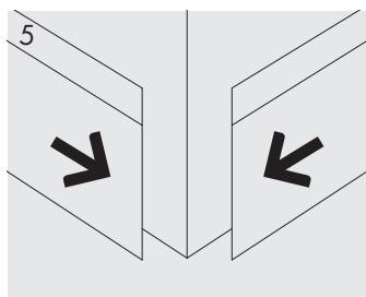
Coller les plinthes au mur dans l'angle extérieur, appuyer dessus et laisser sécher.
