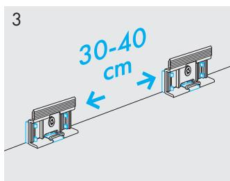
Befestigen Sie die Clips mit Abstandshaltern in entsprechenden Abständen.
