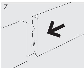
Kleben Sie die Leistenabschnitte an die Wand, drücken Sie sie an und lassen Sie sie trocknen.
