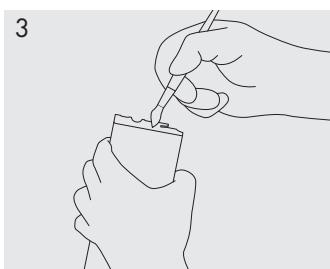
Imprägnieren Sie die geschnittenen Flächen mit der Deckfarbe und lassen Sie sie trocknen.
