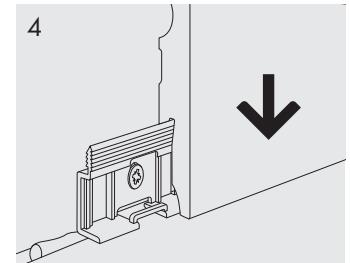
Setzen Sie die Sockelleiste von oben auf den Clip und drücken Sie sie fest.
